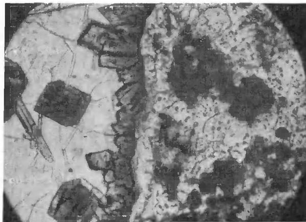
Рис. 2. Искусственный контакт известняка и железистого силикатного расплава, содержащего пары воды. Увеличено в 225 раз
